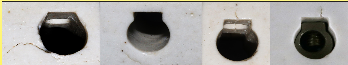
Exemples de fissures sur de la porcelaine C111
