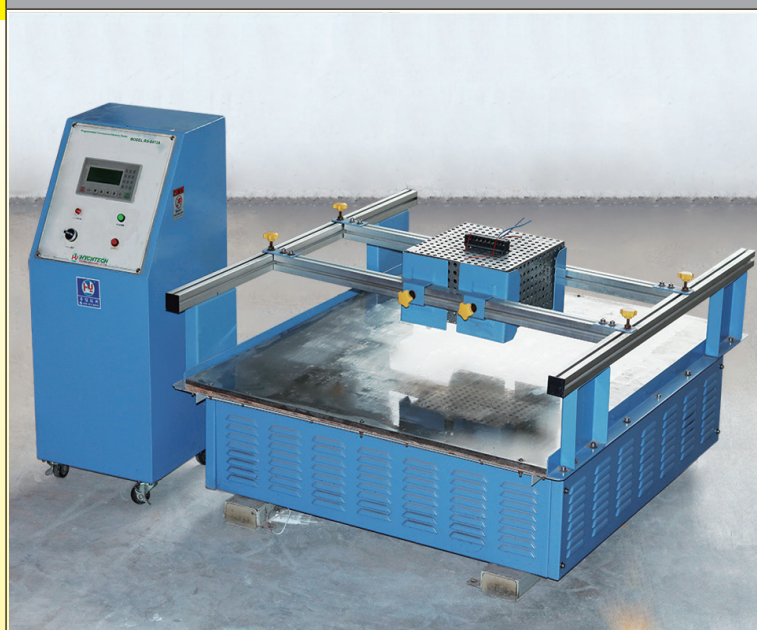
Machine d'essai aux vibrations
